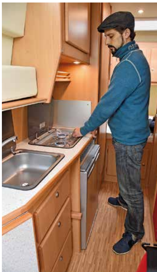
Der Möbelbau besteht, wie bei CS üblich, aus 15 Millimeter Pappelsperholz mit hochwertiger HPL-Beschichtung und wird immer mit Massivholzleisten verarbeitet.
