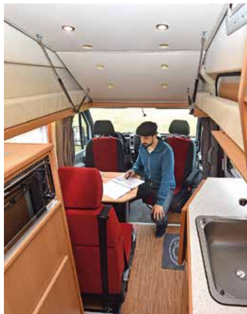
Der Möbelbau besteht, wie bei CS üblich, aus 15 Millimeter Pappelsperholz mit hochwertiger HPL-Beschichtung und wird immer mit Massivholzleisten verarbeitet.
