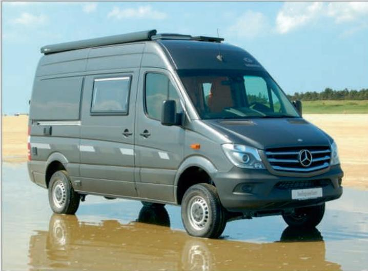
im Fahrerhaus. Zu den umfangreichen weiteren Sonderausstattungs­möglichkeiten gehören unter anderem ein zuschaltbares Untersetzungs­getriebe und Xenon Licht. Das zulässige Gesamtgewicht des Fahrzeugs beträgt 3.500 kg, sodass unser CS Independent im normalen Verkehrsalltag den gleichen Bestimmungen unterliegt wie ein PKW.
